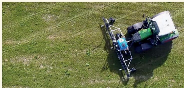
Frontanbaugerät entwickelt, das eine Einzelstockbehandlung auf einer Breite von 6 Metern ermöglicht. Das Gerät wiegt rund eine Tonne mit gefüllten Tanks und kombiniert künstliche Intelligenz mit modernster Sprühtechnik.
